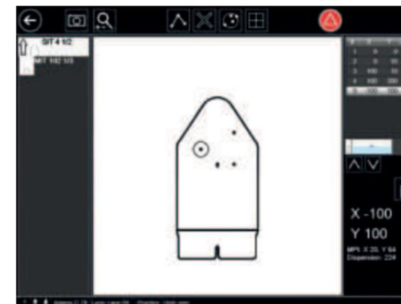
**Monitor de Pontuação (FDU – Fire Display Unit)** – com o LOMAH, o monitor fornece feedback instantâneo ao soldado depois de cada tiro, incluindo a exibição gráfica dos acertos, as coordenadas de localização do projétil (x, y) no plano do alvo, o ponto médio de impacto (MPI – Mean Point of Impact) e a dispersão.
