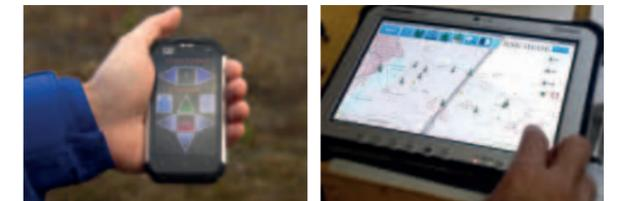
**HHC 10** – Controle remoto portátil para operar até 10 alvos. Totalmente robustecido (à prova d'água IP68 e queda de 1,8 m; temp. de operação de -25 °C a +55 °C).
