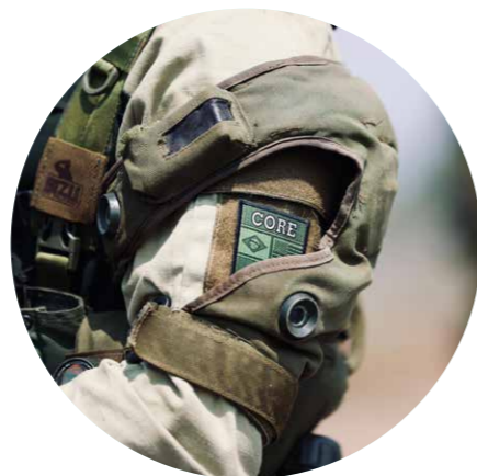
Los Dispositivos de Detección Personal (DDP) pueden colocarse en el chaleco y en el casco del soldado
