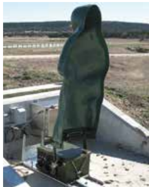
Blanco de infantería estacionario (SIT, por sus siglas en inglés) – Diseño robusto con motor y electrónica en una caja hermética. Es capaz de sostener blancos de varios tamaños mediante un soporte flexible.
