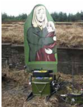
Blanco giratorio – Tiro de reacción y discernimiento de amigo y enemigo. El blanco giratorio incluye soporte para varios blancos.
