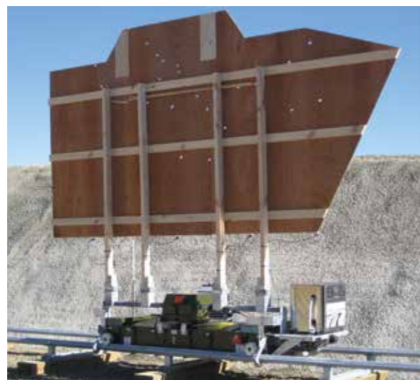
Blanco móvil de blindado (MAT, por sus siglas en inglés) – Capaz de elevar 136 kg (300 lbs). Corresponde a un blanco de 5 x 2,5 m con vientos de hasta 15 m/s (35 mph).
