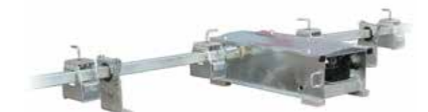
Blanco estacionario pesado de blindado (HSAT, por sus siglas en inglés) – Capaz de elevar 181 kg (400 lbs). Corresponde a un blanco de 7 x 2,5 m con vientos de hasta 15 m/s (35 mph).
