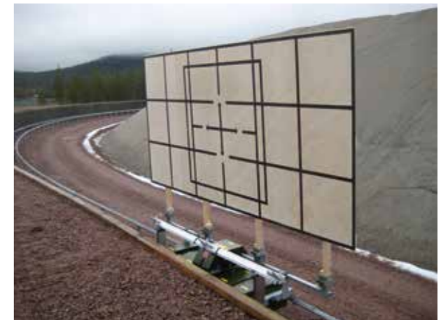
LOMAH 3000 Para blancos de blindado estacionarios y en movimiento. Área de detección de 12 x 5 m (ancho x alto).
